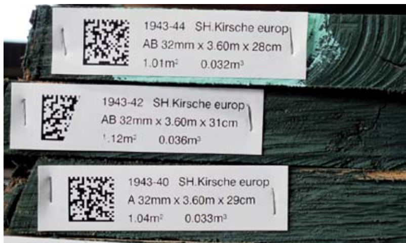
Durch den Barcode kann jedes einzelne Brett gefunden werden.
