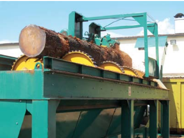
Die Stämme werden mit einer Umschlagmaschine auf die Entrindungs- maschine gelegt und entrindet
